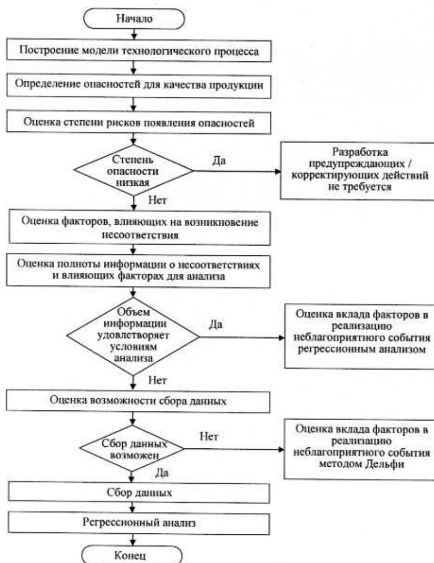
Рис. 3. Блок-схема алгоритма прогнозирования неблагоприятного события для качества продукции
